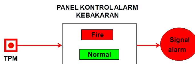
Gambar 2.3.1.(1) - Sistem alarm kebakaran manual
