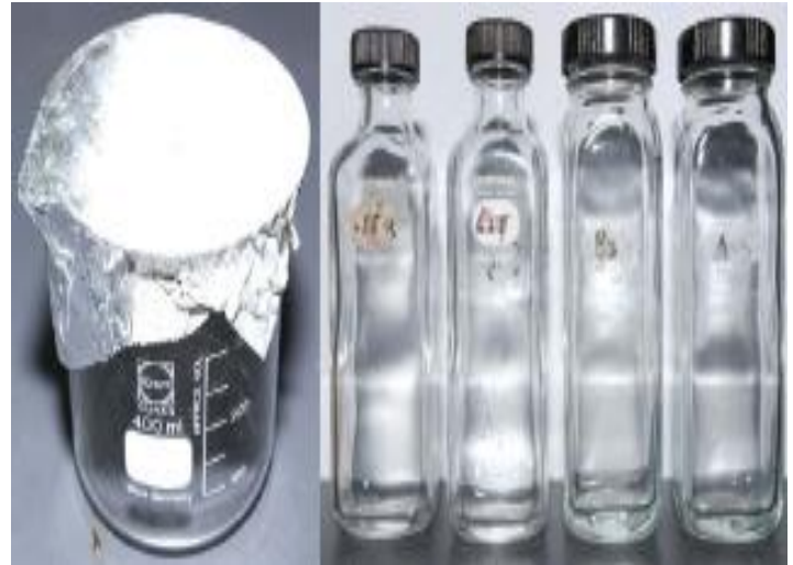
Beaker glass dan botol bermulut lebar (kondisi steril)
