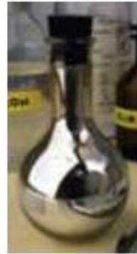
Cermin perak dari reaksi aldehyd dengan reagensia tollens
