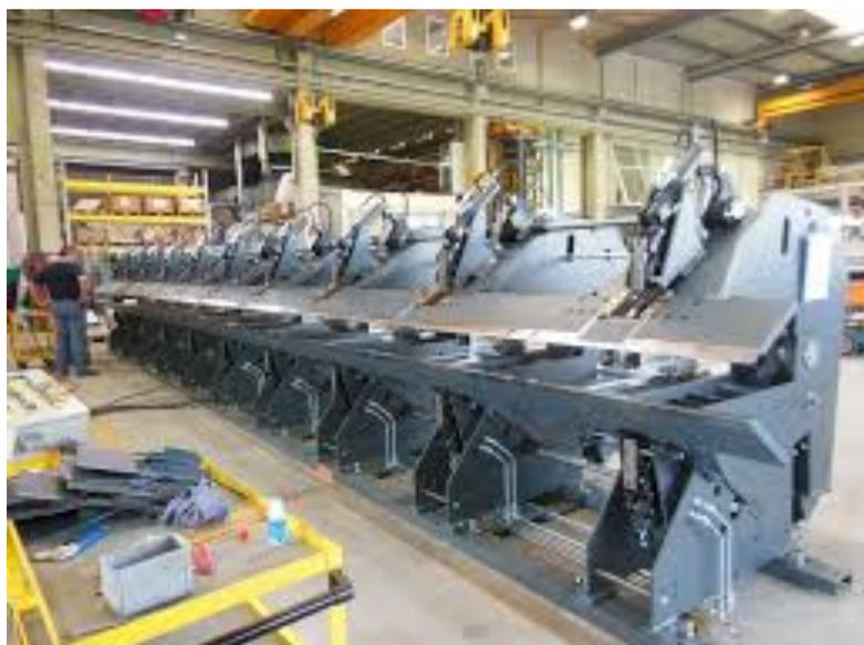
Gambar.6.1. Mesin pemotong plat
