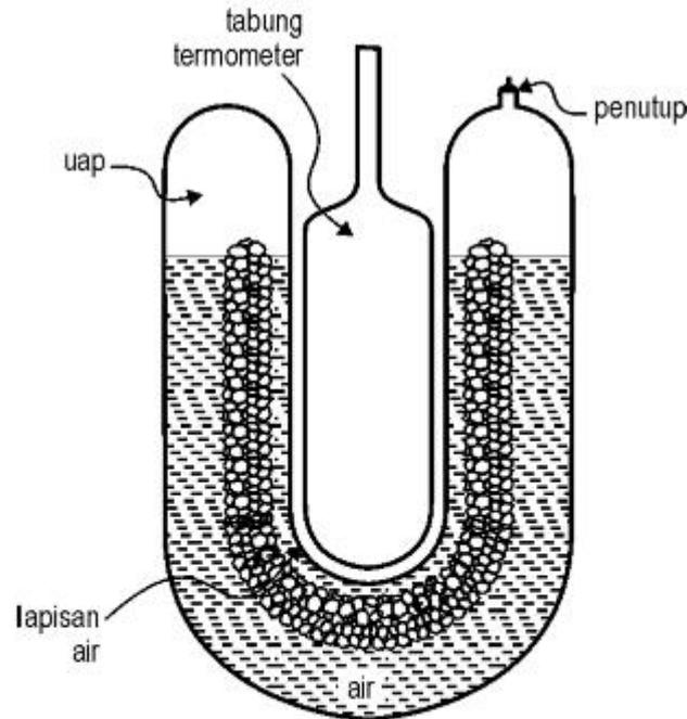
Gambar 1.11. Sel titik *tripel National Bureau of standards*. Sel tersebut mengandung air murni dan disegel (tutup) setelah udaranya dikeluarkan. Kemudian sel tersebut dicelupkan di dalam bak air es. Sistem tersebut berada pada titik-titik *tripel* bila es, air dan uap semuanya ada, dan di dalam kesetimbangan di dalam sel tersebut. Termometer yang akan dikalibrasi dicelupkan di dalam sumur tengah.
