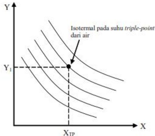
Gambar 1.10. Pengaturan skala temperatur yang meliputi penentuan nilai numerik pada isotermal dari sistem standar yang dipilih (termometer)
